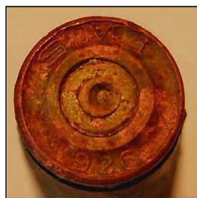
Fig. 182. 6,5 x 52 mm Carcano, de la Societa Metallurgica Italiana (1926). (Registrado en la fosa común)
